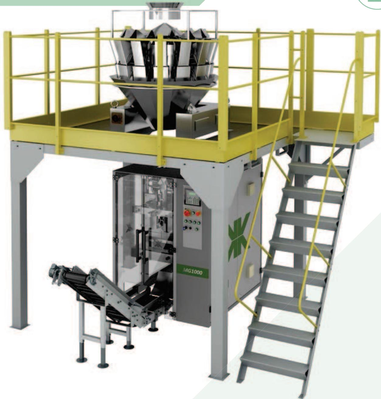
Dosador indicado para o fracionamento de produtos de forma irregular ou com variação no peso específico. Além da variação pelo número de balanças (10 ou 14 balanças), o dosador pode ser indicado nas versões de 1,3 l, 2,5 l e 5,5 l, com superfícies em contato com o produto, lisas ou corrugadas, dependendo do produto a ser fracionado.
